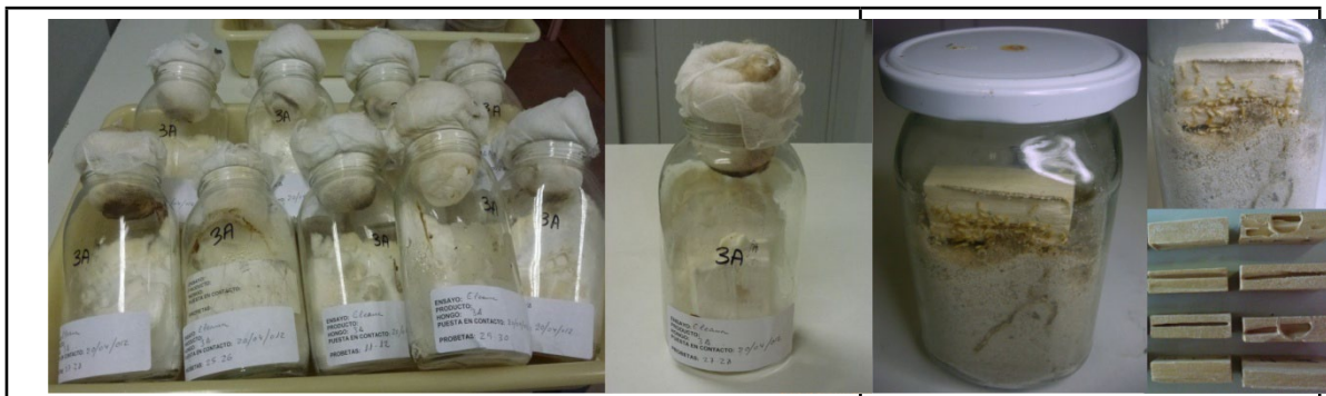
Figura 2. Ensayo con hongos xilófagos (Izq.), con termitas (Der.). Fuente: propia.
